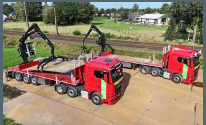
De nieuwe MAN TGX trekker is geschikt voor de extra brede rijplaten die Van Werven Infra vervoert.
